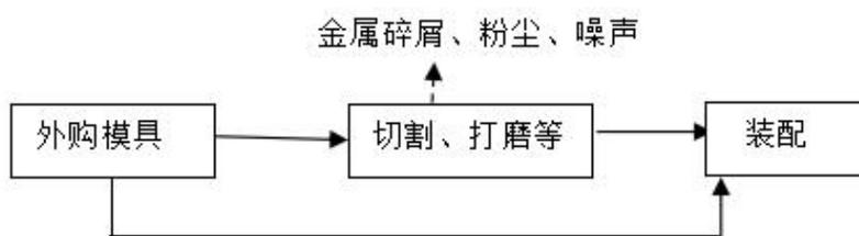
图 11 模具装配生产工艺流程图
