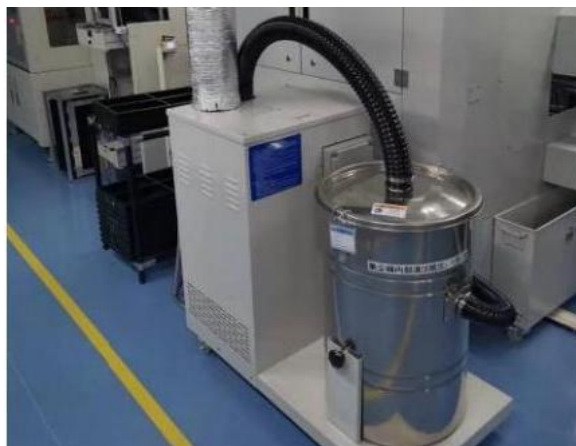
分板机配套袋式除尘器及收集措施
