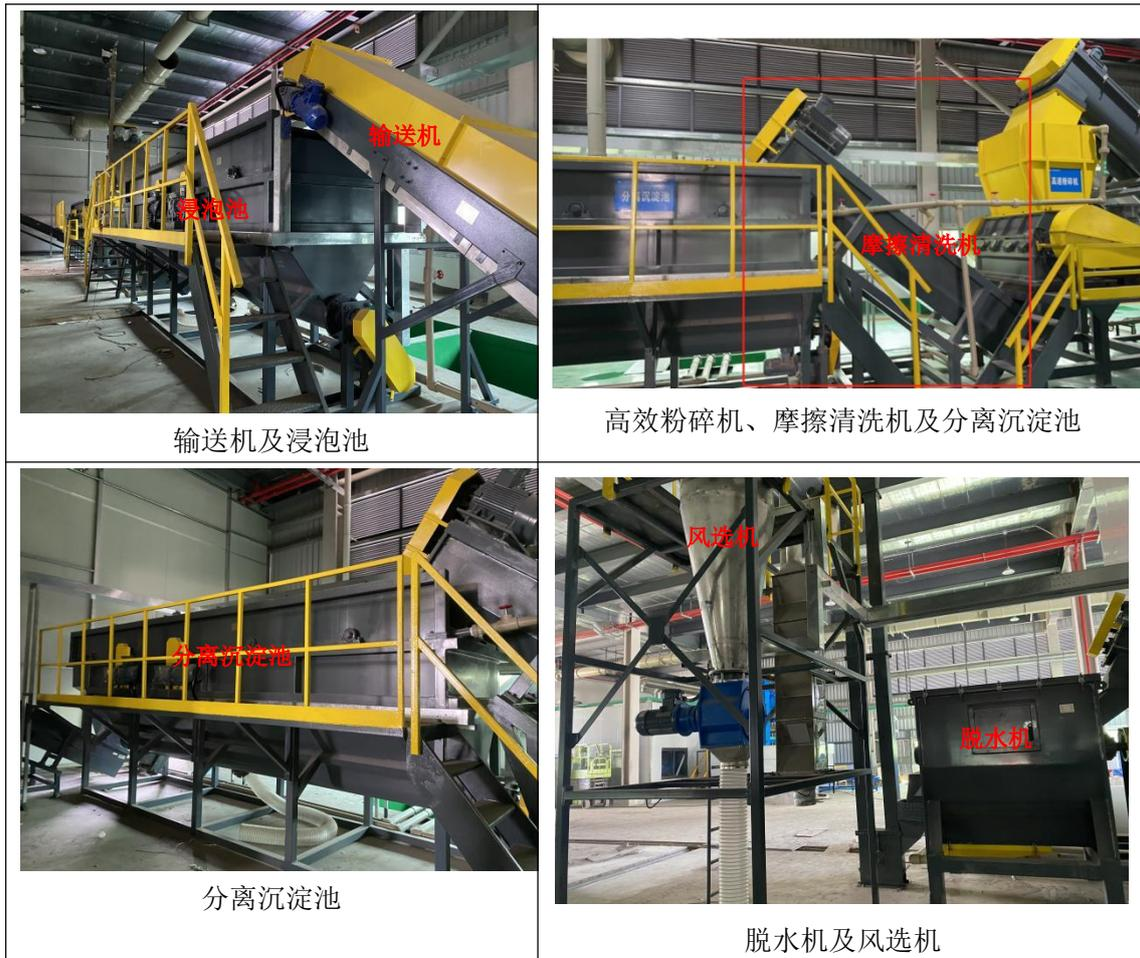
图 3.6-4 项目塑料桶湿法破碎清洗系统现场照片
