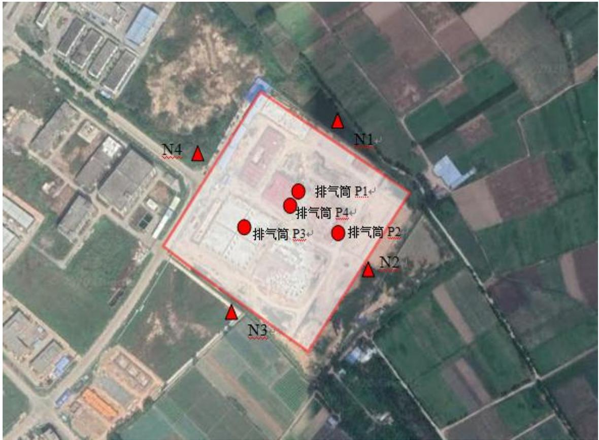
图 7.3-1 项目有组织废气、噪声监测点位示意图
